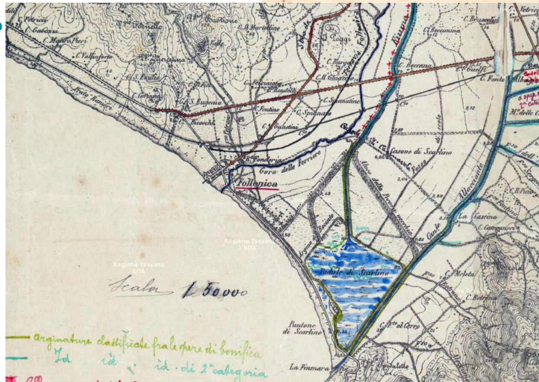
La bonifica idraulica costituisce l'insieme di opere e degli interventi necessari per prosciugare e risanare, a scopi sanitari e produttivi, terreni sommersi, temporaneamente o permanentemente, da acque stagnanti.
