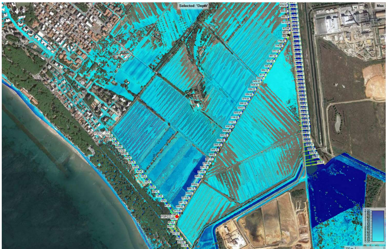
Fig. 53. Mappa istantanea di velocità [200Y_06H] e idrogrammi al LS 1685.3 sulla Gora delle Ferriere. 1+2-D. Plans SA_030/200Y_01/06H.
