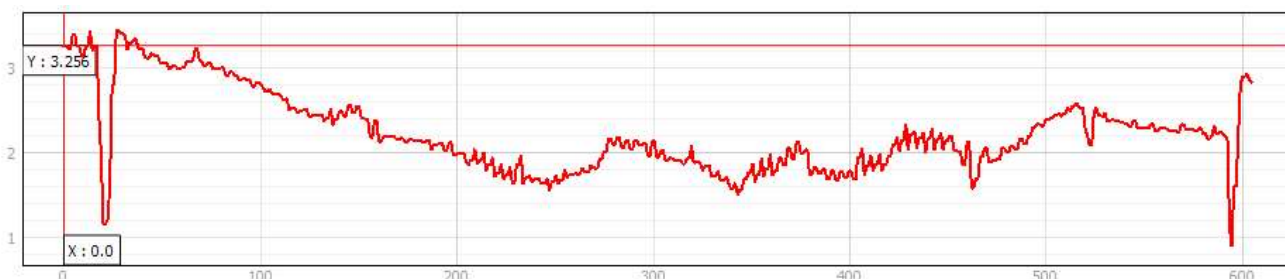
Fig. 93. Profilo morfologico a monte del rilevato FFS tra F.so Valmaggiori (sx) e C.le Mercatone (dx) [tratto da DTM MATTM] e dettaglio delle maxVel. 1+2-D. Plan SA_030(sopra)/200(sotto)Y_02H.
